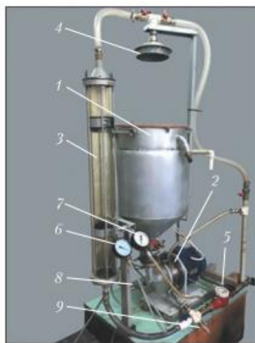
Рис. 2. Аераційно-окислювальна установка роторного типу (АОРТ):
