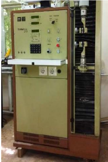
Рис. 3 Машина TIRAtest-2151 для випробування на розтяг
